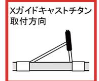
3本脚ガイドの場合はガイドフットの1本足側の方向指示を矢印でお願いします（記載例の図を参照）
