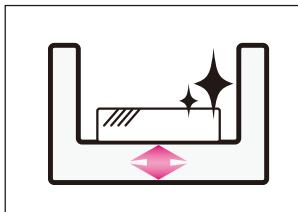
断熱効果の高い底部の断熱材をより厚くし、スペース、重量を無駄に増やさず効率よく保冷力を向上しました。
