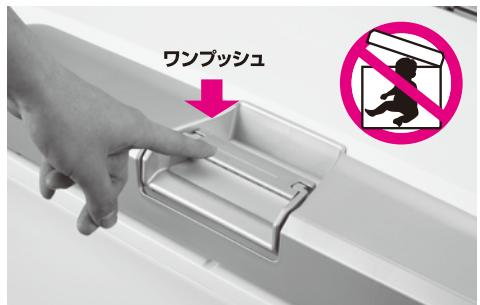
ワンプッシュでロックする構造は、意図しないとロックがかからない構造です。不慮の閉じ込めを防ぐ設計になっています。(※レバーが浮いた状態は、ロックが掛かっていません。)この状態で反対側から開けると蓋が脱落する可能性があります。また蓋を閉める前にレバーを戻してもロックしない構造です。蓋を上げてレバーを引き上げた状態から閉めなおしロックしてください。
