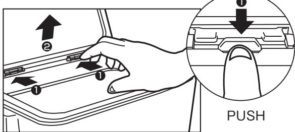
内部のレバーのロックをOFFにして簡単に取り外せます。洗いやすく釣行後のメンテナンスが快適です。
