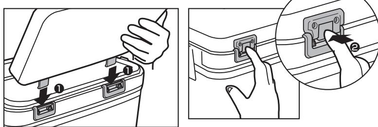
左右のジョイント部を本体部にセットし、フタを閉じてからロックを押し込むだけで取り付け完了です。
