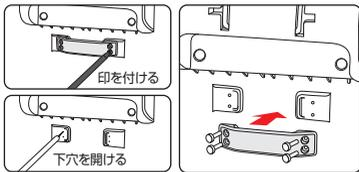
クーラー本体両端にある所定の取付位置にベルト通しを取り付けます。あらかじめ、ベルト通しを取付位置に合わせ、ネジ穴から取付位置に油性マーカー、キリ等で印を付けた後、小さな下穴を開けます。貫通させずに、凹み程度でもかまいません。付属のネジで固定してください。※ネジ直径 半分以上の穴は開けないでください。※ネジが効かなくなります。※取付前に埃など拭き取り、取付面をきれいしてください。※ネジは強く締め付けすぎないでください。ネジが効かなくなります。
