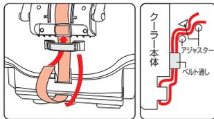
本体のベルト通し穴に図のようにアジャスターで固定してください。
