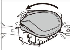
※サイドプレートを外した状態で開口部を下に向けると、スプールが脱落し、変形する恐れがありますのでご注意ください。
