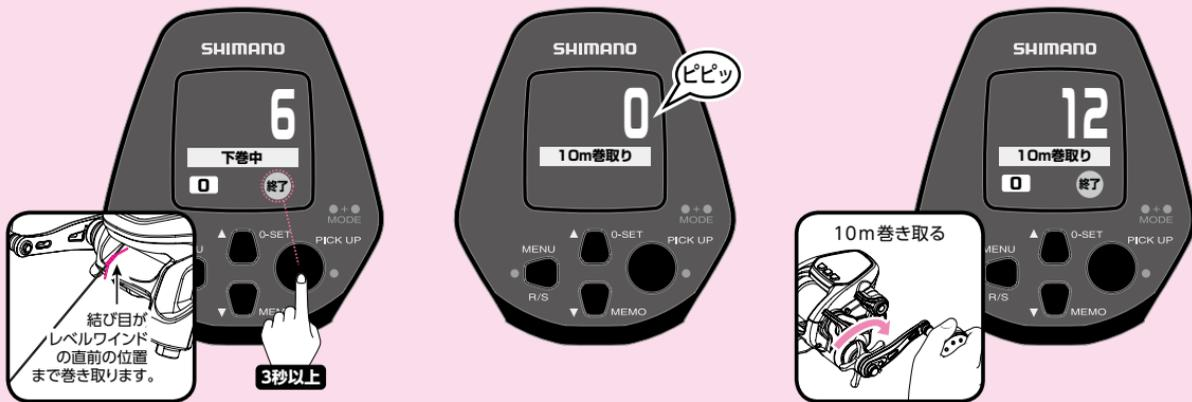
**4** 上図のようにハンドルで結び目まで巻き取ると、上図の画面になりますので、PICK UPボタンを3秒以上押してください。
