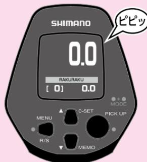
**2** 上図のように表示が変わります。これで、コンピュータが自動的に高切れした位置からの実測値表示にプログラムを変更します。
