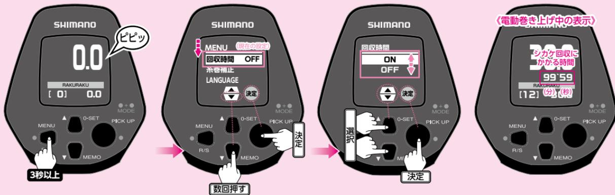
**1** 出荷時は仕掛回収時間OFFで起動します。図の水深表示はOFFになっている場合の例です。水深画面でMENU(メニュー) ボタンを3秒以上押しすとメニュー画面が表示されます。
