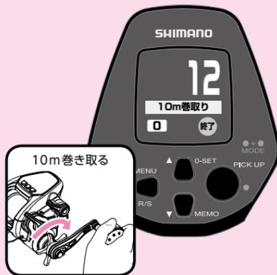
**4** 上図のようにハンドルで結び目まで巻き取ると、上図の画面になりますので、PICK UPボタンを3秒以上押ししてください。
