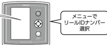
② 探見丸子機の電源を ON にし、リール固有の ID ナンバーを選択してください。これでアクセス完了です。
