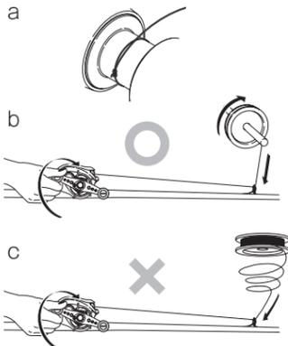
尚、PE ラインを巻かれる時は、事前に PE ラインを十分に湿らせてください。巻き上げ時に発生する熱（抵抗熱）によって PE ラインが劣化するのを防ぐためです。
