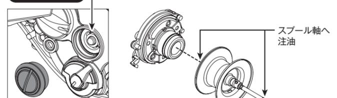
※サイドプレート側の注油穴キャップの取り外し/取り付けは、マイナスドライバーを使用してください。取り付け時は底当たりする（最後）まで締めてください。
