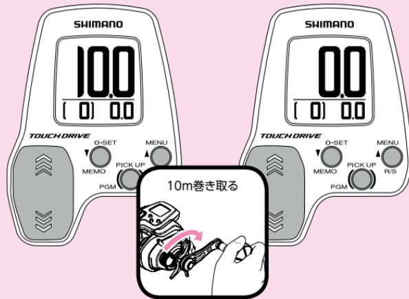
**10** 糸を正確に10m引き出します。(糸の10mごとの色の変化、もしくは1mごとのマーカーの数で確認します。) 学習を終了するため、PICK UP(チョイ巻)ボタンを3秒以上押ししてください。「ピピッ」のアラームが鳴ります。
