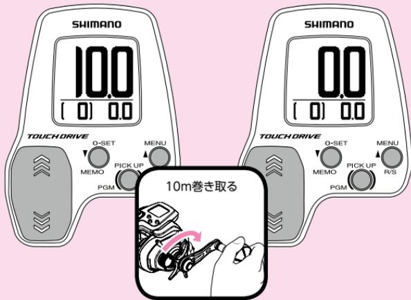
**10** 糸を正確に10m引き出します。(糸の10mごとの色の変化、もしくは1mごとのマーカの数で確認します。) 学習を終了するため、PICK UP(チョイ巻)ボタンを3秒以上押ししてください。「ピピッ」のアラームが鳴ります。
