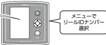
②探見丸子機の電源をONにし、リール固有のIDナンバーを選択してください。
