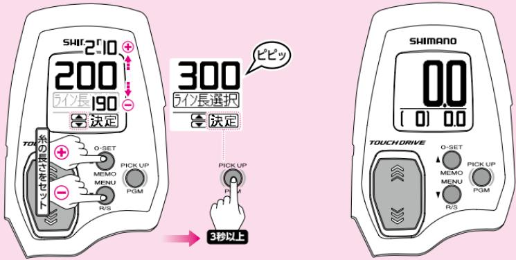
**10** ▼▲ボタンで糸の長さをセットし、PICK UP(チョイ巻)ボタンを3秒以上押してください。
