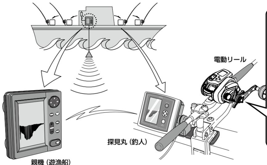
さらに探見丸システム対応電動リールと組み合わせることで、双方間に通信が可能となり、使い勝手が広がります。
