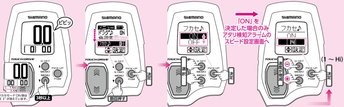
1 電源を入れた際はフカセモードOFFで起動します。糸巻学習「フロロ学習 E2」の終了後は、フカセモードが自動的にONになります。
