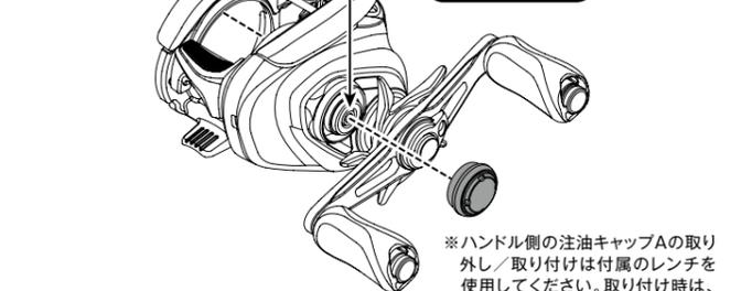
※ハンドル側の注油穴キャップAの取り外し/取り付けは付属のレンチを使用してください。取り付け時は、スプールがガタつかない程度に取り付けてください。強く締めすぎたり、緩すぎる場合、キャスト性能に影響します。
