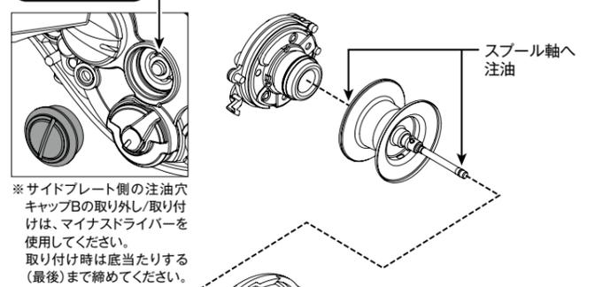
※サイドプレート側の注油穴キャップBの取り外し/取り付けは、マイナスドライバーを使用してください。取り付け時は底当たりする(最後)まで締めてください。
