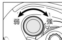
一般的な調整は次のように行います。リールをロッドにセットして、ガイドに糸を通し、使用するルアーを結びます。ロッドを水平にして、クラッチを切り、ルアーがゆっくりと落ちていく程度に調整します。
