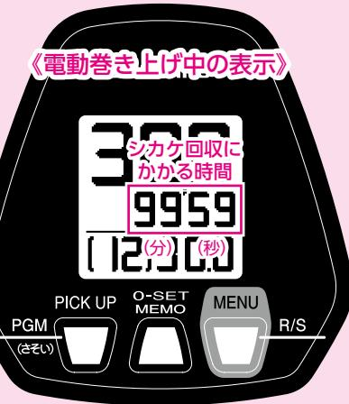
仕掛け回収時間ONを決定した場合、水深画面に戻ると表示が図のように変化し、電動巻き上げの際にシカケ回収にかかる時間を表示します。
