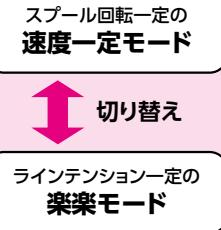
巻き上げパワーが一定の「楽楽モード」と、巻き上げスピードが一定の「速度一定モード」の切り替えで、状況に応じた巻き上げが可能です。
