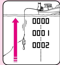
電動巻き上げ時に、シカケが船べりに回収されるまでにかかる時間を表示します。
