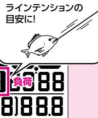
モーター巻上げ時、ラインテンションの目安を表示します。ドラグ調整や、巻き上げスピードの調整などでハリス切れを防ぐことができ、また、魚の匹数や大きさの目安にもなります。
