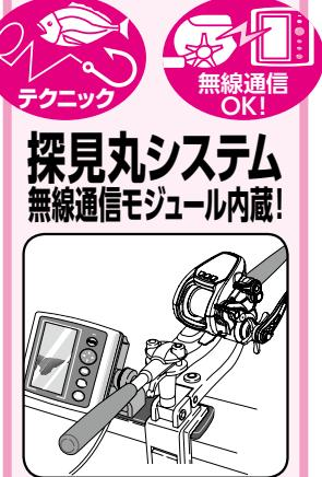
船べりで魚探が見える探見丸システムと組み合わせることで双方間に通信が可能となり、使い勝手が広がります。この製品にはデジタルカウンター内部に無線通信モジュールが内蔵されていますので、通信ケーブルを必要とせず、探見丸子機と無線通信できます。
