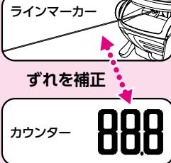
実際のラインマーカーとカウンターのm数を補正することで、より正確な棚取りを行えます。
