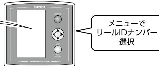
① 電動リールの電源を ON にして、無線通信機能を ON にし、リール ID ナンバーを表示させてください。
