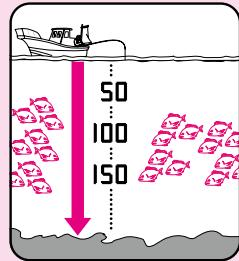
リアルタイムで海底の水深がわかります。海底の水深を表示します。また、フィッシュマークが出ると魚がいる水深を表示し、アラームで通知します。
