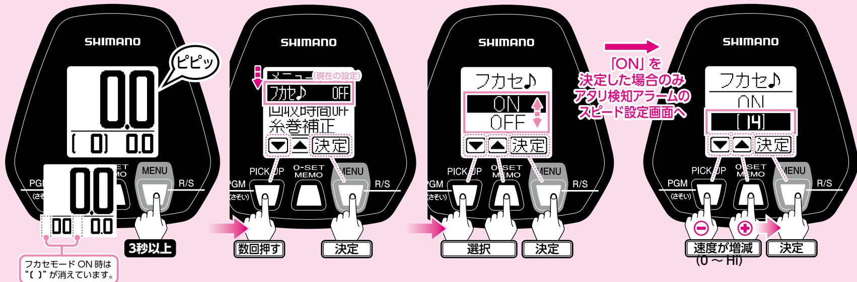
1 電源を入れた際はフカセモードOFFで起動します。糸巻学習「フロロ学習 E2」の終了後は、フカセモードが自動的にONになります。
