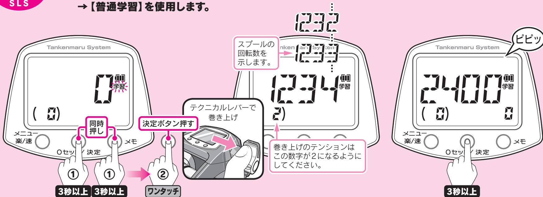
**1** カウント値が6 m以下で操作します。6.1m 以上の時は0セット (35 ~ 36 ページ参照) しておきます。クラッチレバーをONにしてください。そして、電源の接続を確認してください。決定ボタン、メモボタンを両方同時に3秒以上押しすと学習モードに入ります。「学習」(普通学習) が点滅します。決定ボタンを押し、普通学習を決定します。「学習」が点灯に変わります。(学習モード内での学習方法の選択について、詳しくは18 ~ 19 ページ「学習方法の選択」をご参照ください。)
