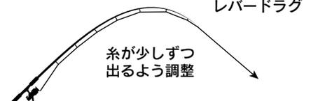
4. この状態で、糸が少しずつ出ていくようにプログラマを調整します。通常は糸切れを起こす寸前の力でスプールが空転し、糸が出ていくように調節してください。
