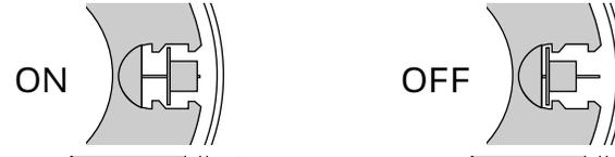
パーツケースの中に、リールに組み込まれている大きさと同じブレーキブロックと、異なる大きさのブロックを、それぞれ6個、スペアパーツとして付属しています。大きさの異なるブロックの組み合わせを、スプールにセットすると、より微妙な調整が可能になります。【“大(イエロー)をセット ブレーキが 大” “小(ブルー)をセット ブレーキが 小”】この“SVS”により、ルアーのウエイト、空気抵抗、そして、風のフォロー、アゲインストなど、さまざまな釣場状況に応じて適正なブレーキ力をかけることが可能となり、バックラッシュなしの遠投ができます。メーカー出荷時には、ブレーキブロック2個を“ON”の状態に設定しています。お買い求めいただいて、糸を巻き、このリールではじめてキャストするときには、6個のブレーキブロックをすべて“ON”にすることをおすすめします。その後“ON”のブロック数を調整してください。通常は、2~3個のブレーキブロックを“ON”の状態にしておくのが適切です。
