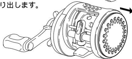
3. 左サイドプレートが回転し、内部機構が現れます。この状態でSVSの調整を行うことができます。また、左サイドプレート内側に透明の防塵シールドを設けることで、砂・ゴミの侵入を防ぐ構造になっています。
