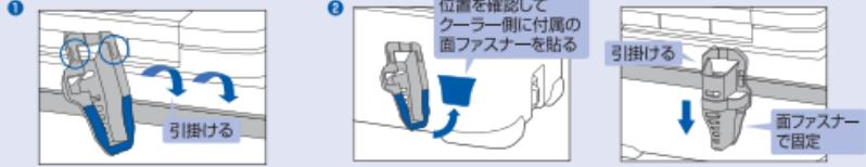
裏面のフック2本をアクセサリーベースに引掛けます。取り外す場合は、ロッドレスト下部を手前に引き、面ファスナーを外してから、本体を上へ引き上げてください。
