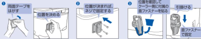
位置合わせをしてから、ホルダー裏側に付いている両面テープで任意の位置(平滑な所)に仮止めし、付属のネジで固定してください。
