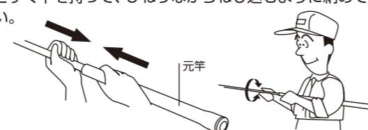
この時、仕舞う節の継ぎ部付近をそれより太い節の玉口内側に当たらないように注意してください。玉口の端で細い節を傷める恐れがあります。仕舞う時に傷めると、次回釣行時に荷重がかかった際に破損する恐れがあります。
