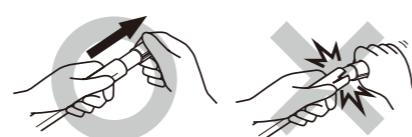
●糸ガラミしたままで使用しないでください。また、取り込みの時などは、無理によせたり垂直方向への引き抜きは、やめてください。竿の一部に無理な力がかかり破損の原因になります。
