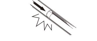
■落ちた節を無理に引き出すと、穂目の内側と玉口が当たって、これも同様に玉口割れ、竿尻割れ、竿内側割れ、これらによる竿折れの原因となります。尻栓をはずして一本ずつ抜き取ってから、再度巻き直すようにしてください。使用中は時々竿のゆるみを確認して、ゆるみを取ってください。
