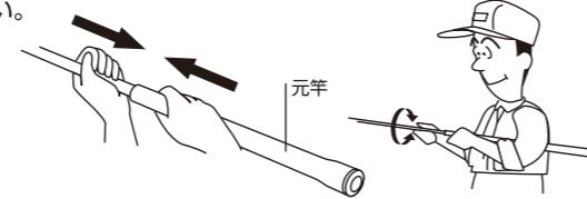
この時、仕舞う節の継ぎ部付近をそれより太い節の玉口内側に当たらないように注意してください。玉口の端で細い節を傷める恐れがあります。仕舞う時に傷めると、次回釣行時に荷重がかかった際に破損する恐れがあります。
