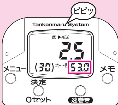
シカケが6秒以上停止していた水深（6.1m以上の場合）は、棚として自動的にメモリーされ、船べり停止時に画面右下に表示します。（□部分）
