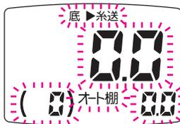
※注意 この時、モーター保護のためモーターをON・OFFせずに5分以上休ませてください。(この際、ハンドルで糸を巻いたり、クラッチを切って糸を出したりしても糸巻学習は保持され、カウンターは正常に働きます。) 点滅が点灯になればブレーカーは復帰です。
