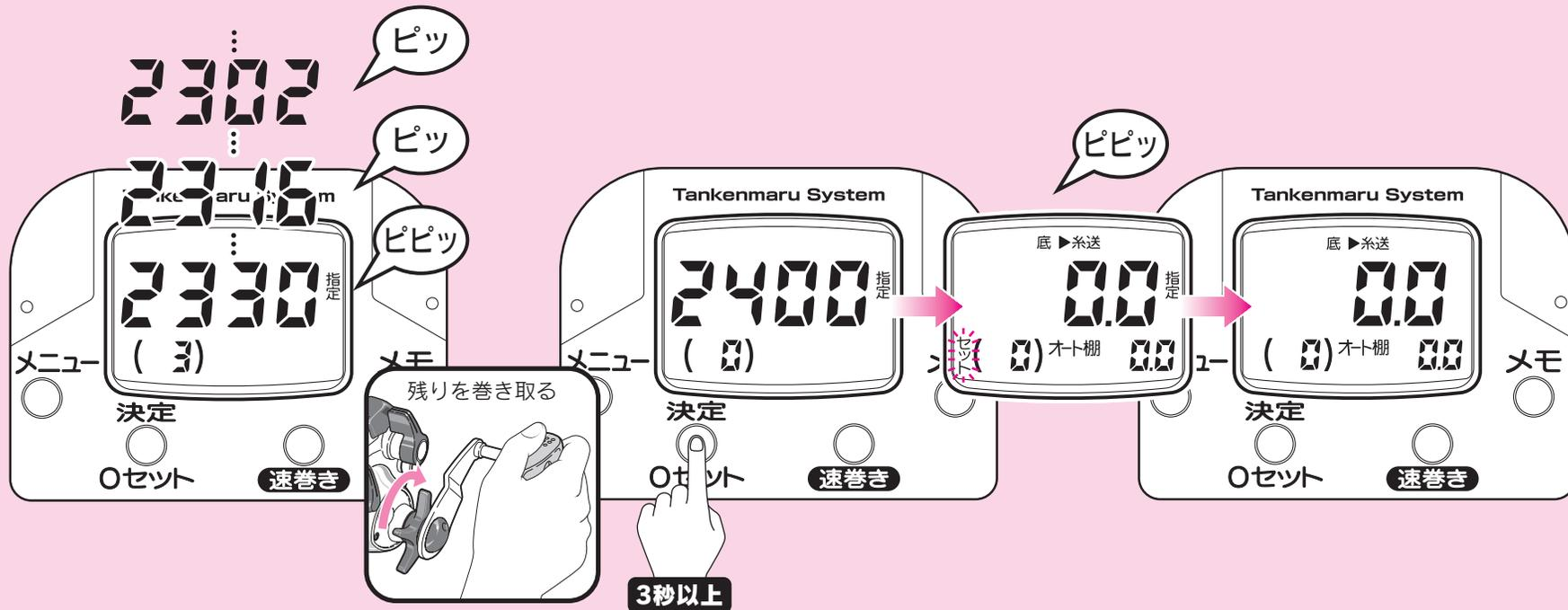
**4** テクニカルレバーでの巻き上げの場合、残り約10mでアラームが鳴って、自動的にストップします。ストップしたらテクニカルレバーを「0」にして、残りの糸を手巻きで巻いて下さい。
