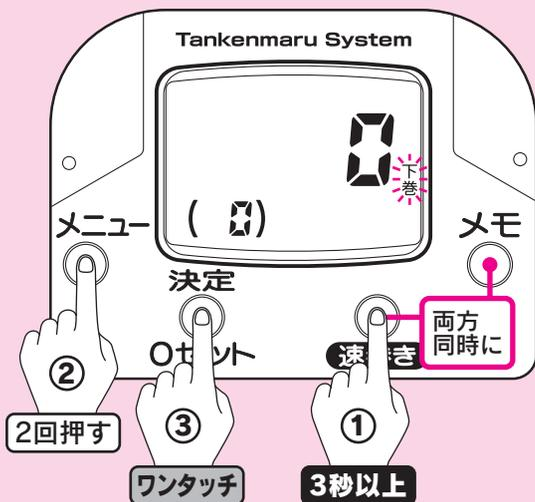
**1** カウント値が6m以下で操作します。6.1m以上の時は0セット (26~27ページ参照) しておきます。メモスイッチ、速巻きスイッチを両方同時に3秒以上押して学習モードに入り、メニュースイッチを2回押してください。「下巻」(下巻学習) が点滅し、表示は図のようになります。決定スイッチを押し、下巻学習を決定します。「下巻」が点灯に変わります。(学習モード内の学習方法の選択について、詳しくは9ページ「学習方法の選択」をご参照ください。)
