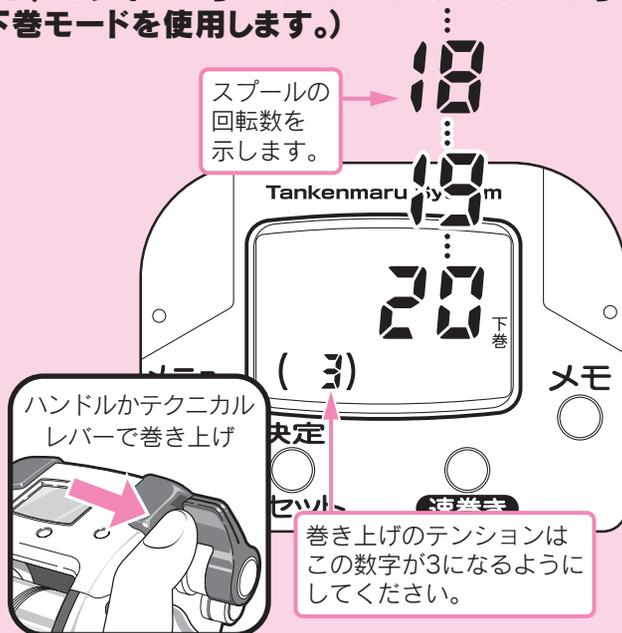
**2** 右の要領でそれぞれ下巻を行います。ハンドルかテクニカルレバーで糸を巻いてください。(糸巻学習時、速巻きスイッチは無効です。) 巻き上げのテンションは( )内の数字が3になるようにしてください。テクニカルレバーでの巻き上げの場合、速度はテクニカルレバーで調節できます。巻き上げを止めるときは、テクニカルレバーを「0」にしてください。
