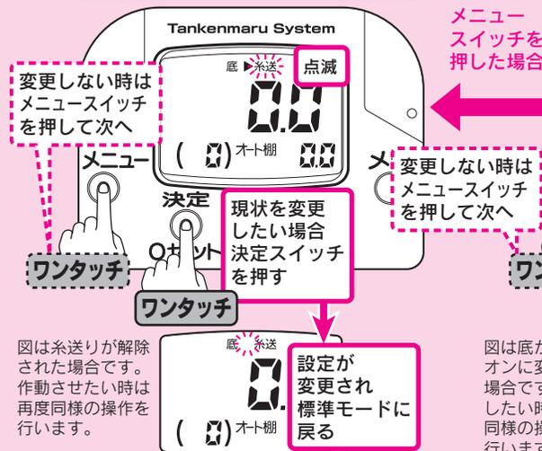
図は糸送りが解除された場合です。作動させたい時は再度同様の操作を行います。
