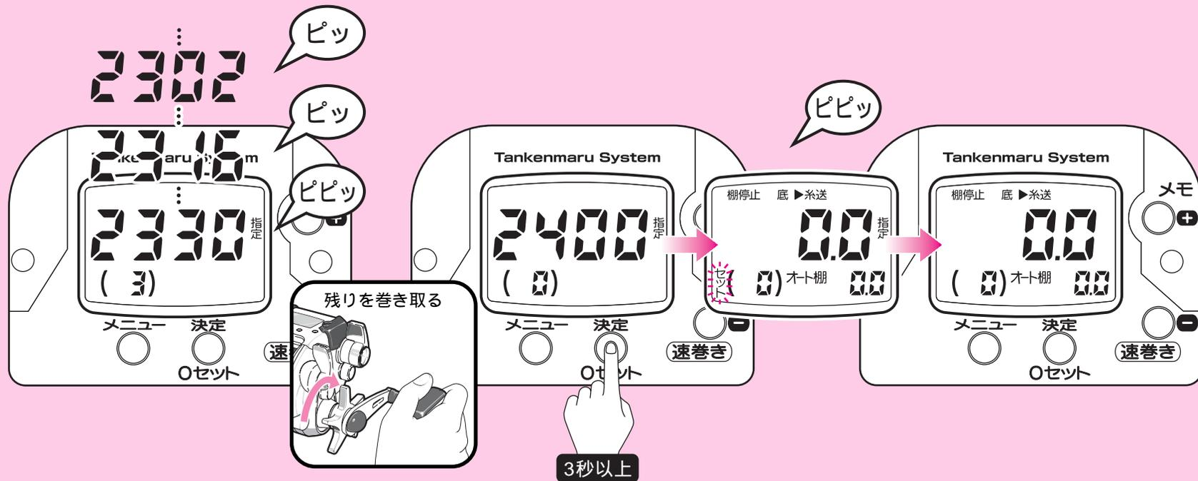
**2** テクニカルレバーでの巻き上げの場合、残り約10mでアラームが鳴って、自動的にストップします。ストップしたらテクニカルレバーを「0」にして、残りの糸を手巻きで巻いて下さい。
