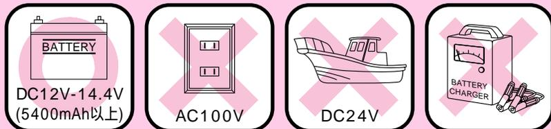
船に備え付けの電源を利用される時は、電圧が直流（DC）12Vから14.4Vであることをご確認ください。（船のバッテリーをご使用になる場合は、12Vを直接とるのではなく、DC-DCコンバータにより24Vから12Vに変換されたものに限ります。）また、端子がサビしているとリールが正常に作動しない場合がありますので、サビを取り除いてご使用ください。
