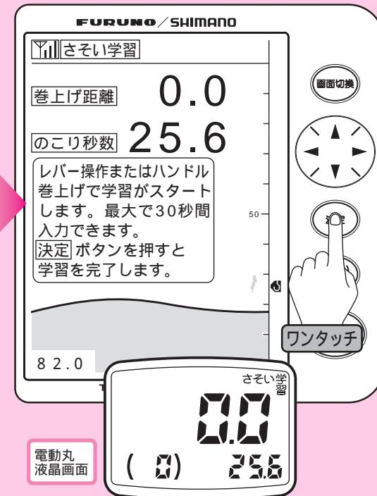
いったんスプールが回って入力が開始されると、その後の静止状態も入力されます。比較的短い操作をくり返すときは、その1回分の入力だけで記憶を終了します。図はテクニカルレバー最高速で巻き上げ、3秒静止後の例です。
