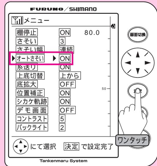
**1** あらかじめ[棚停止] [ON]の選択および棚停止水深の設定、50～55ページまでの「さそいの準備」を行うと、[オートさそい]の 囲みが点灯し、機能が有効になります。これで機能の設定変更および使用が可能です。図の設定は例として表示しています。
