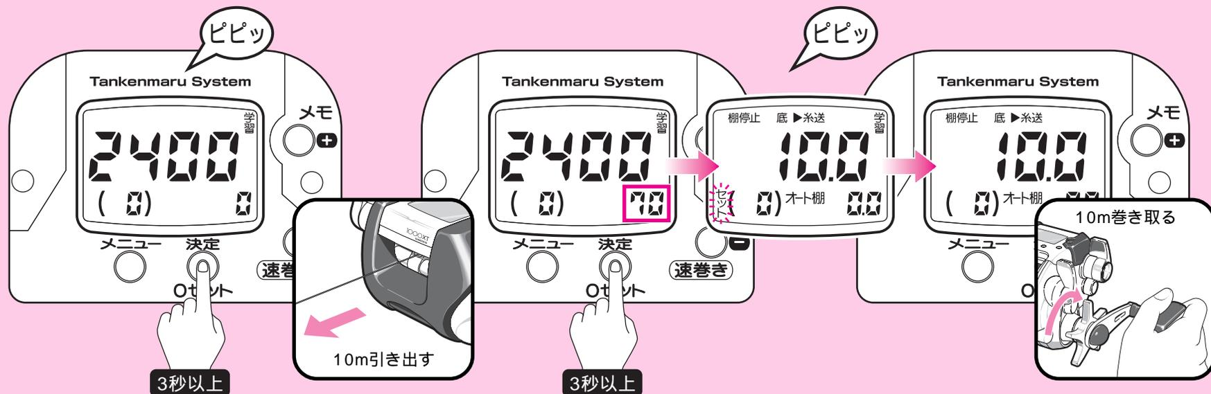
**4** 糸を完全に巻き終えたら、決定スイッチを3秒以上押してください。「ピピッ」のアラームが鳴り、表示は図のようになります。糸を正確に10m分引き出します。(糸の10mごとの色の变化、もしくは1mごとのマーカの数で確認します。)
