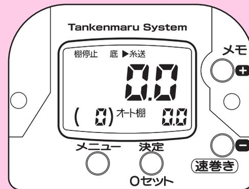
**3** これで、コンピュータが自動的に高切れした位置からの実測値表示にプログラムを変更します。
