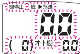
注意 この時、モーター保護のためモータースイッチをON・OFFせずに5分以上休ませてください。点滅が点灯になればブレーカーは復帰です。このような場合でも電源がON状態であれば、糸を巻く、出すことによってカウントされ、水深がずれることはありません。
