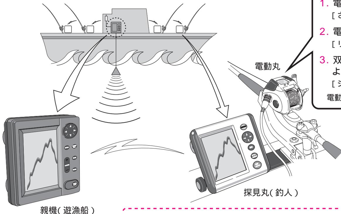
さらに探見丸システム対応電動丸と組み合わせることで、双方向に通信が可能となり、使い勝手が広がります。
