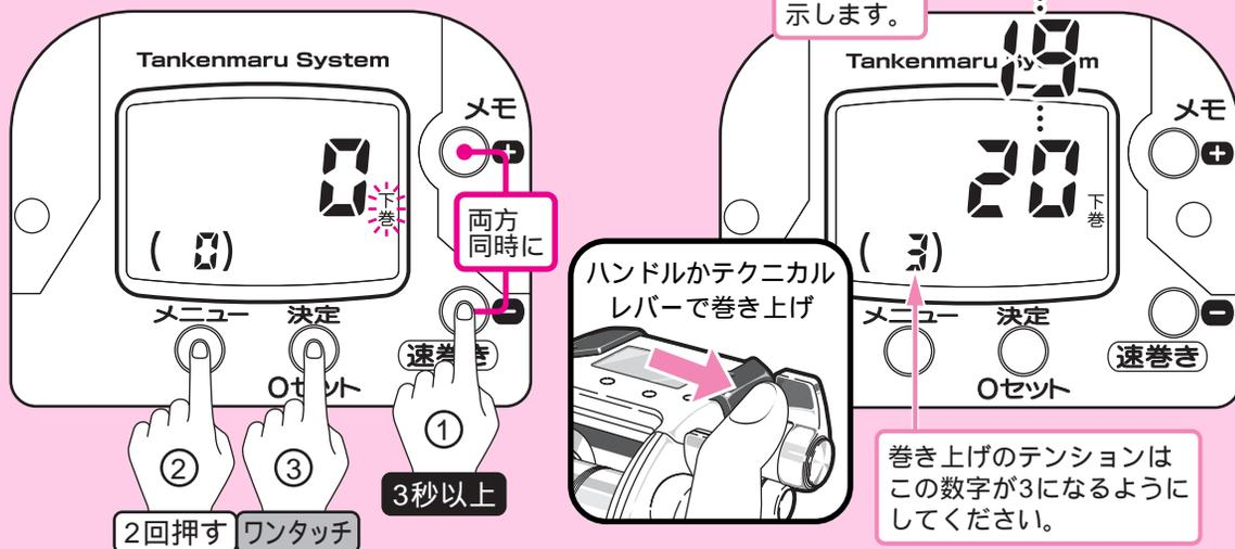
**1** カウント値が6m以下で操作します。6.1m以上の時は0セット(28~29ページ参照)しておきます。メモスイッチ、速巻きスイッチを両方同時に3秒以上押して学習モードに入り、メニュースイッチを2回押してください。「下巻」(下巻学習)が点滅し、表示は図のようになります。決定スイッチを押し、下巻学習を決定します。「下巻」が点灯に変わります。(学習モード内での学習方法の選択について、詳しくは11ページ「学習方法の選択」をご参照ください。)
